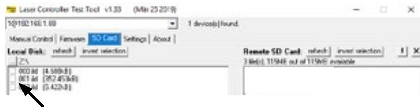
Klicken Sie auf die Schaltfläche mit den beiden Pfeilen nach rechts, um die \*.ild-Dateien auf die eingesteckte microSD-Karte hochzuladen. Die Dateien werden kopiert und gespeichert.
