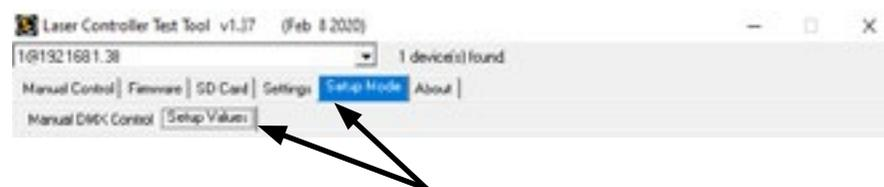
Ajustez les paramètres (outre la sortie laser, la petite fenêtre en bas à droite de l'onglet «Setup Value» affichera également les modifications), puis stockez-les sur la carte mère ShowNET en cliquant sur «Save». La sortie laser clignote trois fois pour confirmer que les modifications ont été enregistrées.
